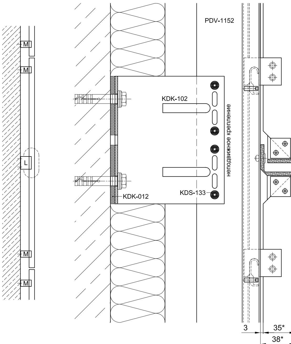
Несущий кронштейн допускается крепить одним дюбелем (анкером) в отверстие по середине или двумя в крайние отверстия. Количество дюбелей (анкеров) для крепления кронштейна определяется прочностным расчетом.
