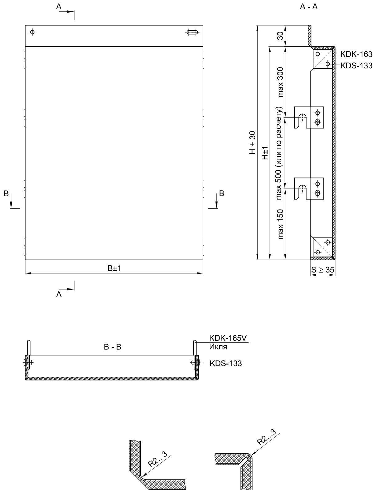
Перед серийной сборкой кассет, требуется изготовить контрольный образец для проверки правильности раскроя и размеров кассеты
