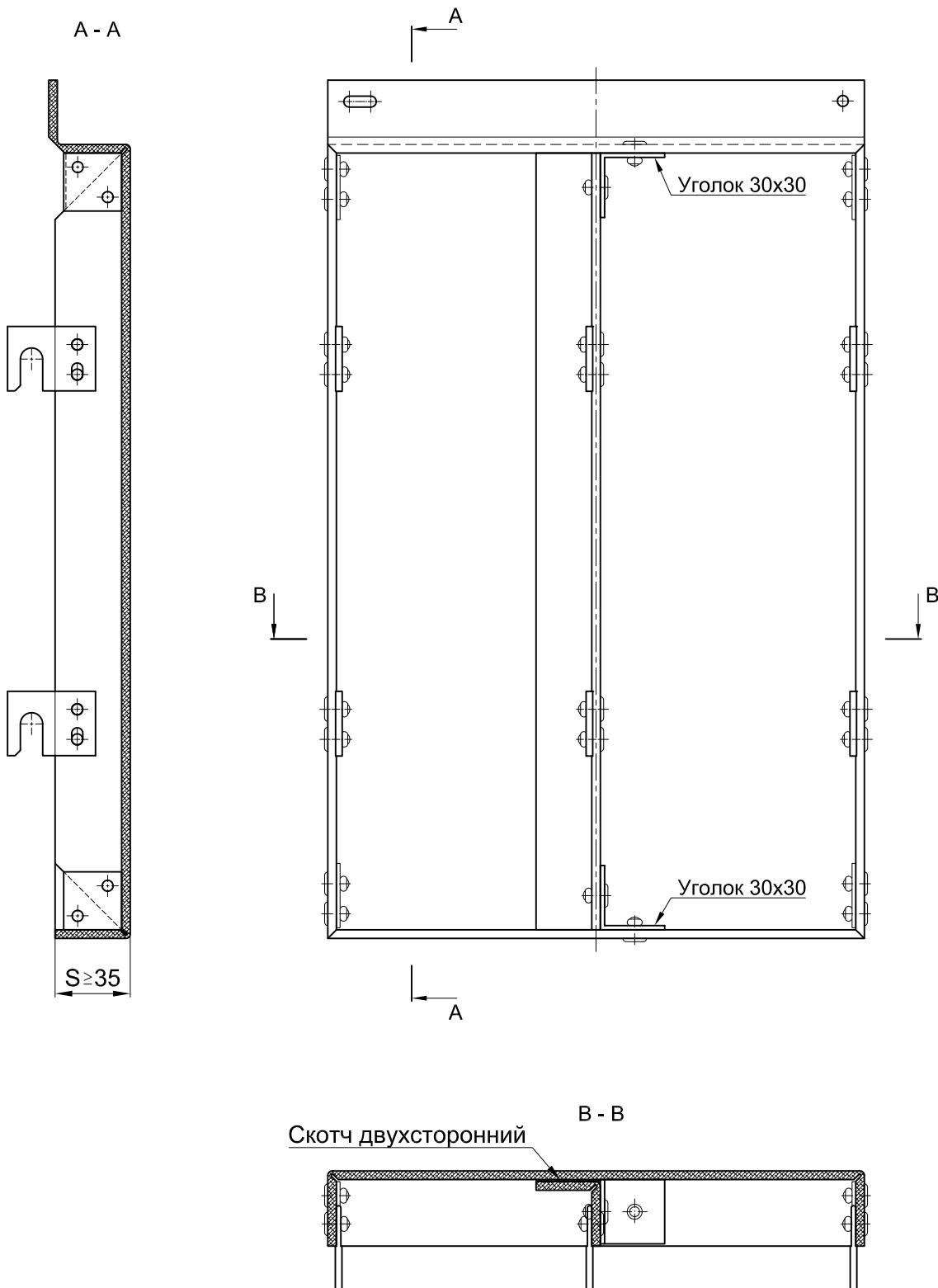
Перед серийной сборкой кассет, требуется изготовить контрольный образец для проверки правильности раскроя и размеров кассеты
