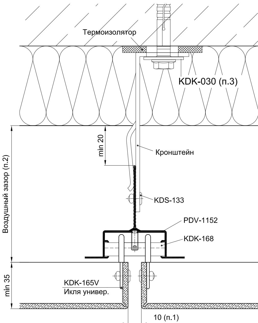
1. Зазор между кассетами 10 мм является рекомендуемым. Требуемый размер зазора указывается в проектной документации на конкретный фасад здания.
