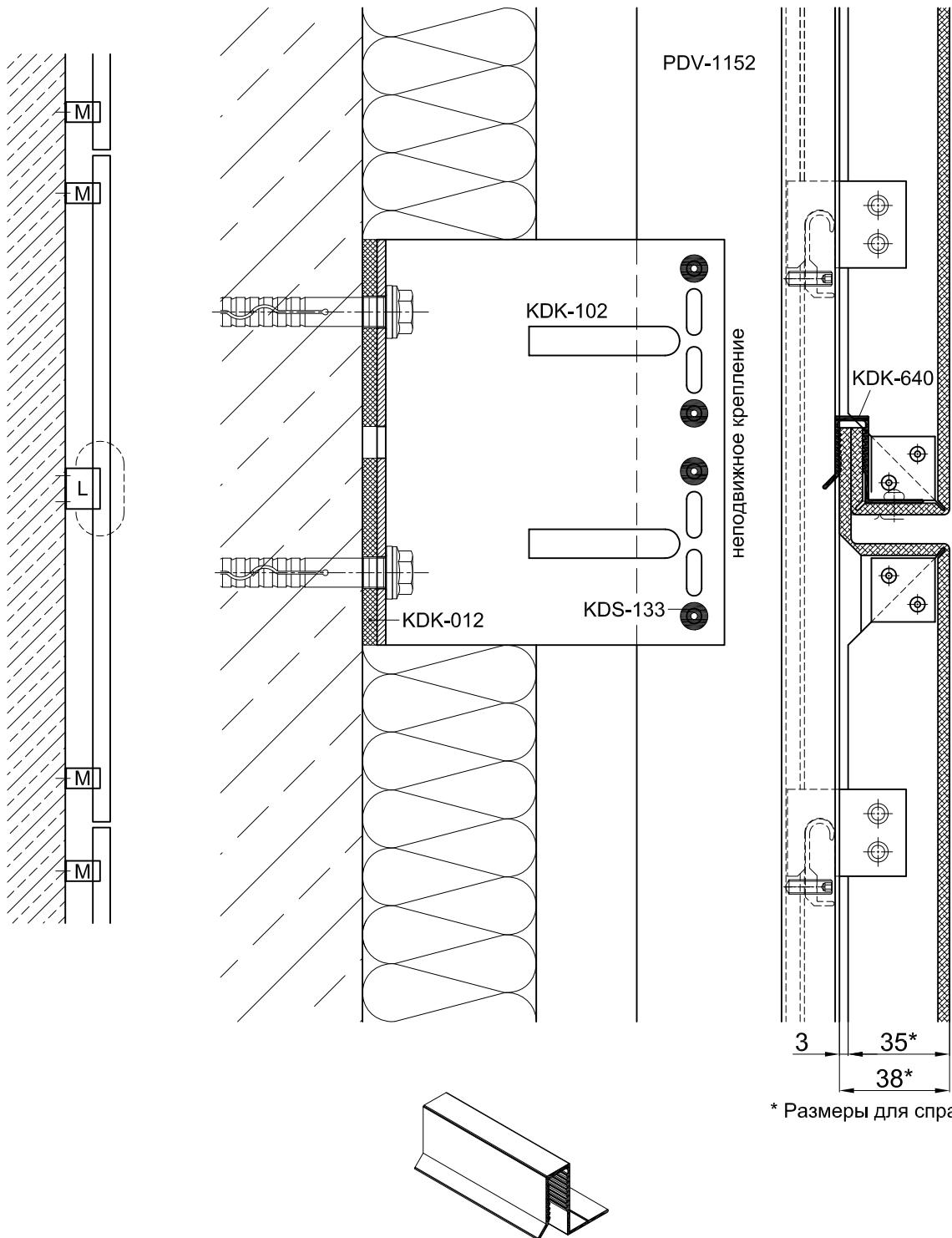
KDK-640 Прищепка L=60 мм служит для усиления горизонтальных ребер кассеты. Прищепка крепится одна по середине кассеты, либо 2 и более с равным шагом, определяемый прочностным расчетом.
