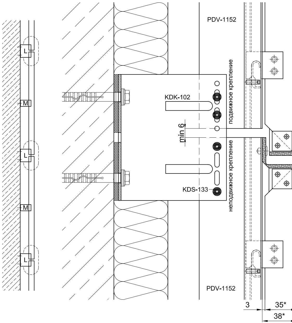
Несущий кронштейн допускается крепить одним дюбелем (анкером) в отверстие по середине или двумя в крайние отверстия. Количество дюбелей (анкеров) для крепления кронштейна определяется прочностным расчетом.
